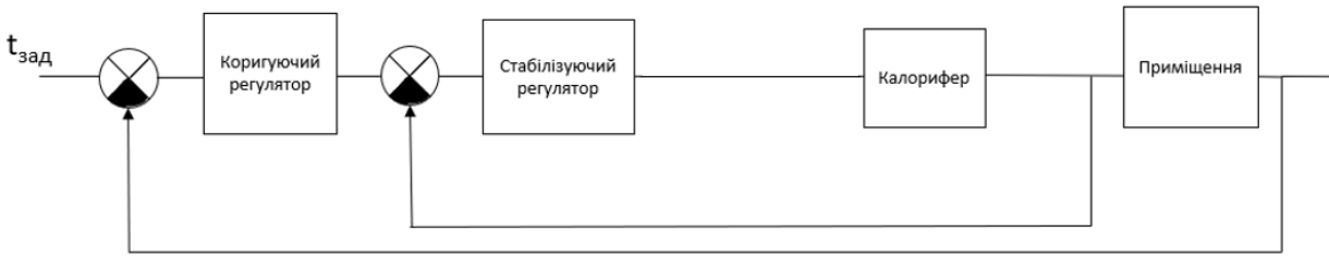
Рис. 20. Структура каскадної системи регулювання WRFPV2V
